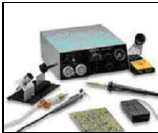
Şekil 3.13: SMD lehim sökme istasyon
