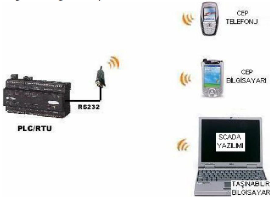
Şekil 1.6: Uzak terminal ünitesinin haberleşebileceği cihazlar
